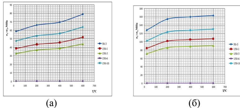
**Рис. 1.** Зависимость макронапряжений в графите от температуры для параллельных (а) и перпендикулярных (б) слоев при воздействии мощного ионного пучка. Источник: [2]
